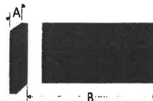
Lorsqu'un auvent et des ailettes verticales sont utilisés simultanément, les facteurs de projection FP pour l'auvent et pour les ailettes doivent être calculés séparément et les coefficients de masque architectural F<sub>ma</sub>, correspondants doivent être déterminés d'après les tableaux précédents. Ensuite, on retient le coefficient de masque F<sub>ma</sub>, le plus petit correspondant aux ailettes verticales ou à l'auvent.
